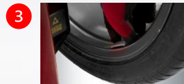
3 Easy weight : pointeur laser pour le positionnement des masses cachées avec répartition derrière les bâtons
